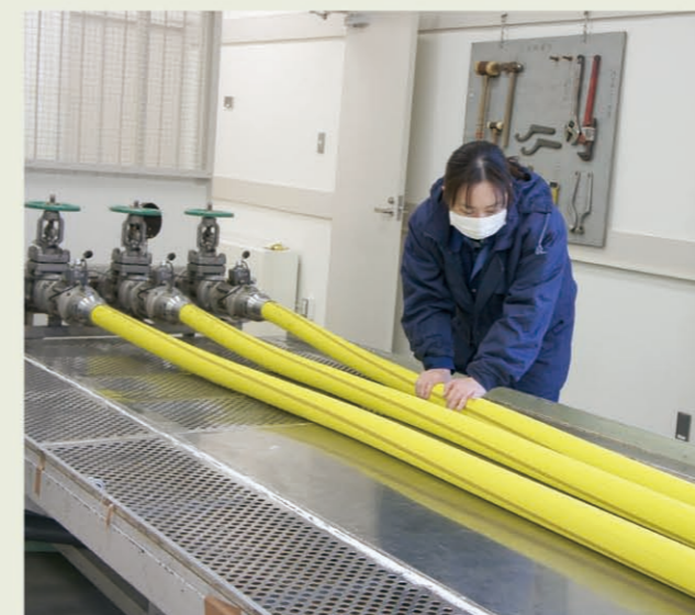
消防用ホースの耐圧試験 Pressure test of fire hoses
