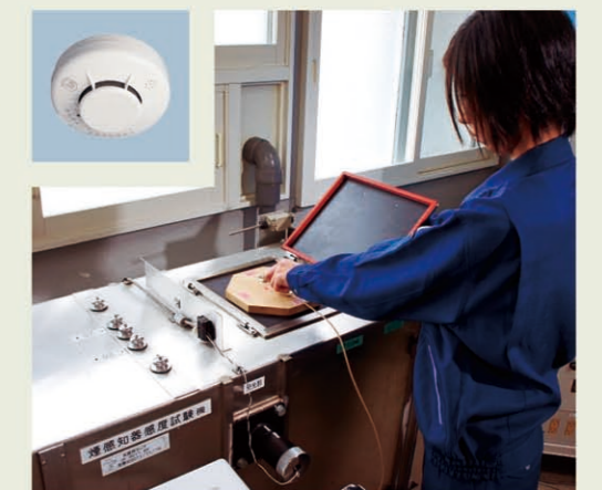
住宅用防災警報器の煙式感度試験 Sensitivity test on smoke alarms
