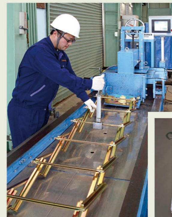
金属製避難はしごの強度試験 Strength test on metallic escape ladder
