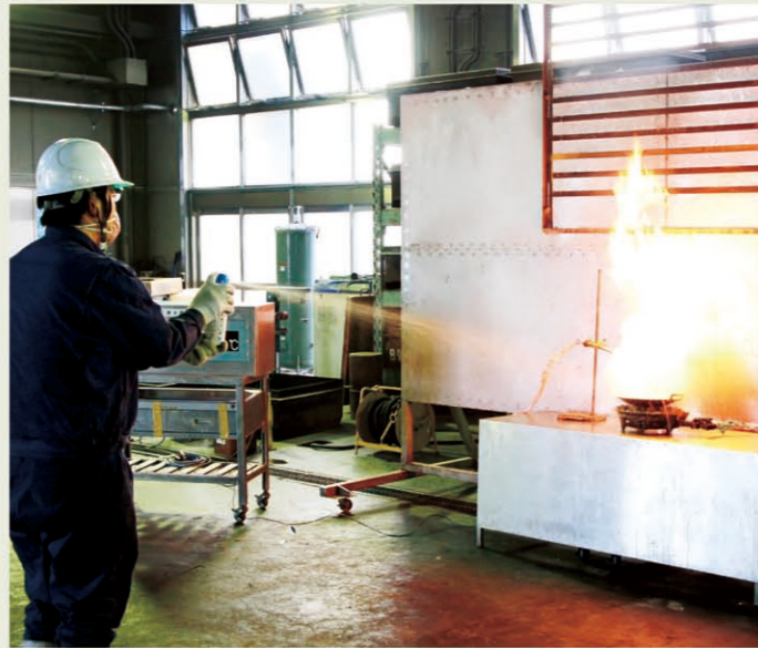
エアゾール式簡易消火具の天ぷら油火災消火試験 Cooking oil fire test with aerosol type disposable fire extinguishers
