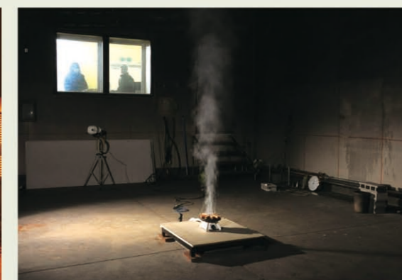
ISO規格 煙感知器の試験 ISO standard test for smoke detector
