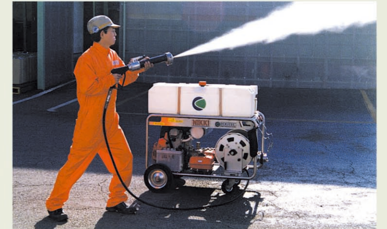
高圧送水装置の吐水性能試験 Discharge test on high pressure pump
