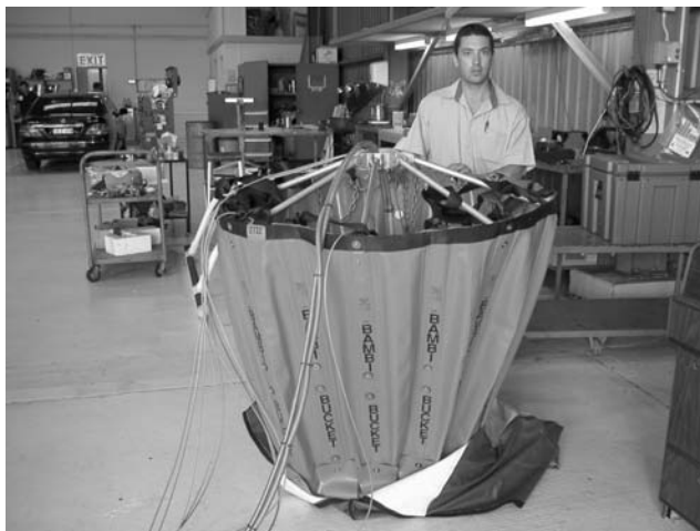
Bell UH-1H ヘリコプターに使用するバケット装置 (積載容量は 1200 リットル)
