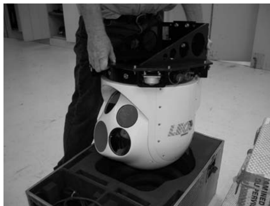
ヘリコプターに搭載する赤外線カメラ（LEO Mk II）
