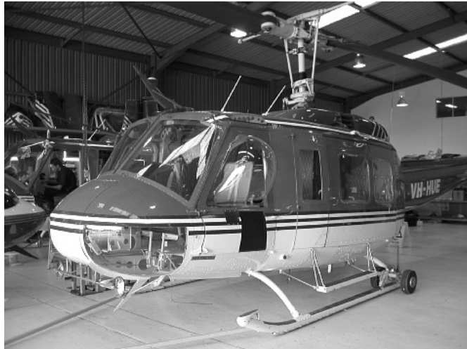
NSW州地方消防隊が長期契約を行っているBELL UH-1H 機長席窓は飛行時に地上が確認しやすいようドーム型になっている
