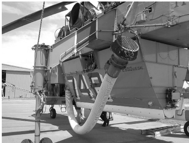
Erickson Air-Crane S-64F Helitanker の貯水タンク 9,500 リットルの水を 50 秒で揚水することができる
