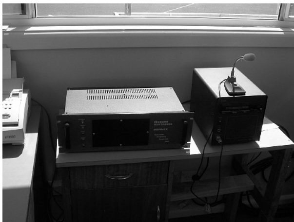
Avdate 社の航空無線受信装置（左）と記録用コンピューター（右）
