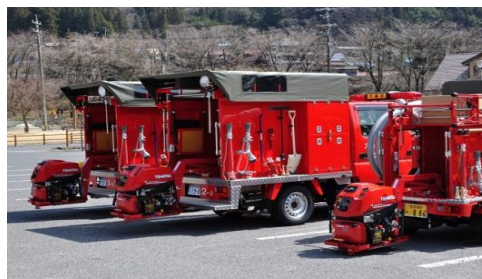
小型動力ポンプ付積載車
